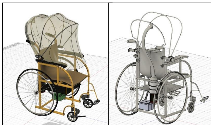
Gambar 4. Rancangan Negative Pressure Wheelchair (NPW) yang dilengkapi dengan HEPA Filter
