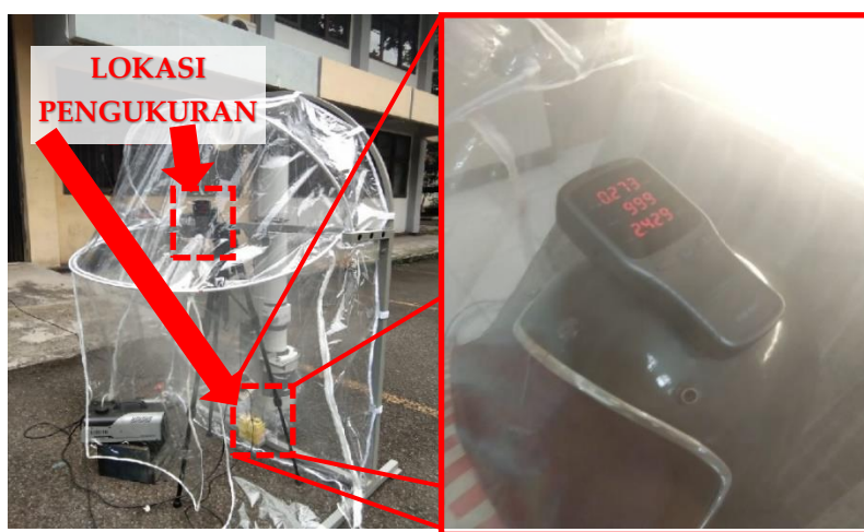
Gambar 9. Proses Pengujian Efisiensi Filtrasi HEPA Filter
