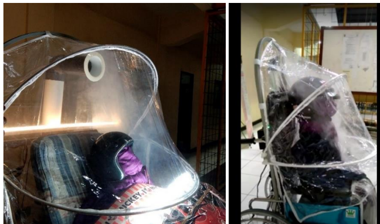
Gambar 8. Proses Pengujian/Visualisasi Pola Aliran pada NPH dan NPW.
